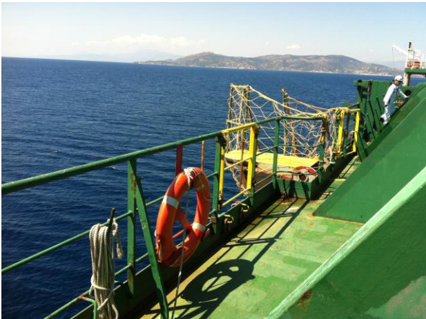
Εικόνα 7: Το κυκλικό σωσίβιο με σχοινί που ήταν τοποθετημένο πρώραθεν της δεξιάς κλίμακας.
