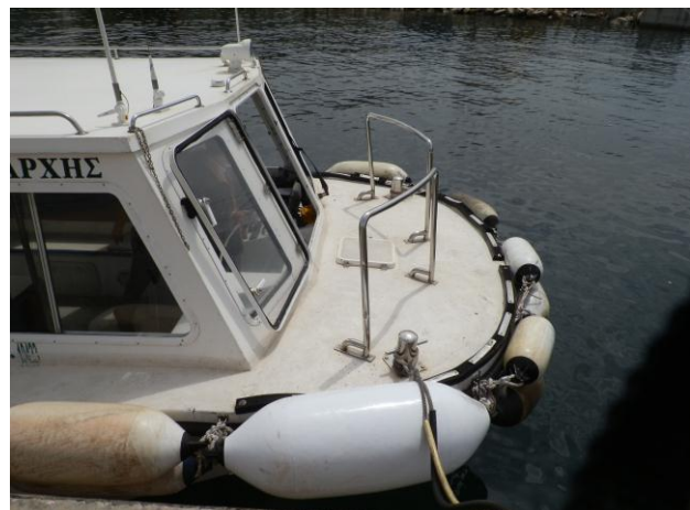
Εικόνα 10: Ο πρωραίος χώρος επιβίβασης/αποβίβασης με το καιροστεγές άνοιγμα για την πρόσβαση στον χώρο επιβατών.
