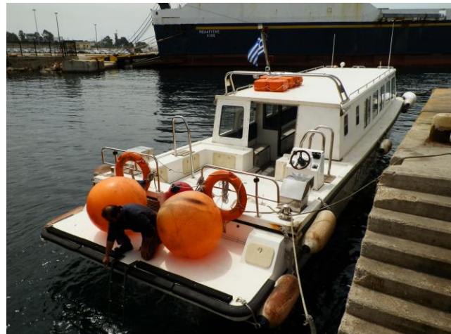
Εικόνα 9: Ο σταθμός ελέγχου στο πρυμναίο εξωτερικό κατάστρωμα
